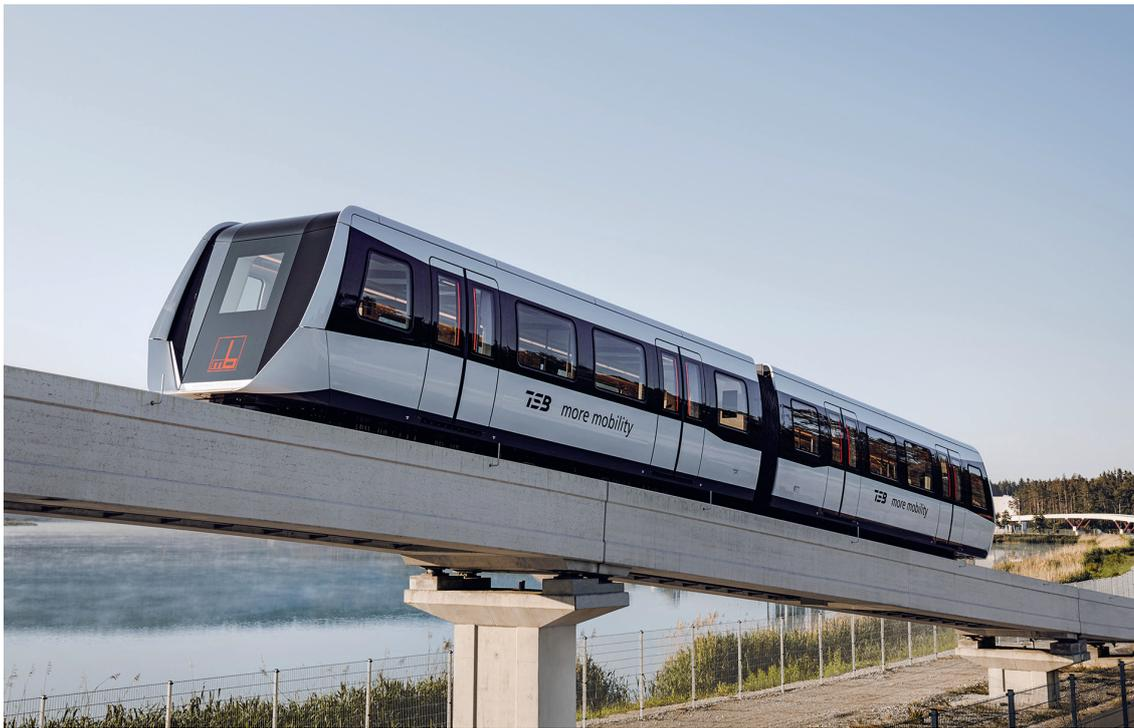
**Bild 2: Um einen absolut zuverlässigen Betrieb des TSB realisieren zu können, entschied sich Max Bögl für Hima-COTS-Steuerungen vom Typ HIMax und HIMatrix, die entsprechend EN 50126, 50128 und 50129 für den Einsatz bis zur höchsten Sicherheitsstufe SIL 4 zertifiziert sind.**
