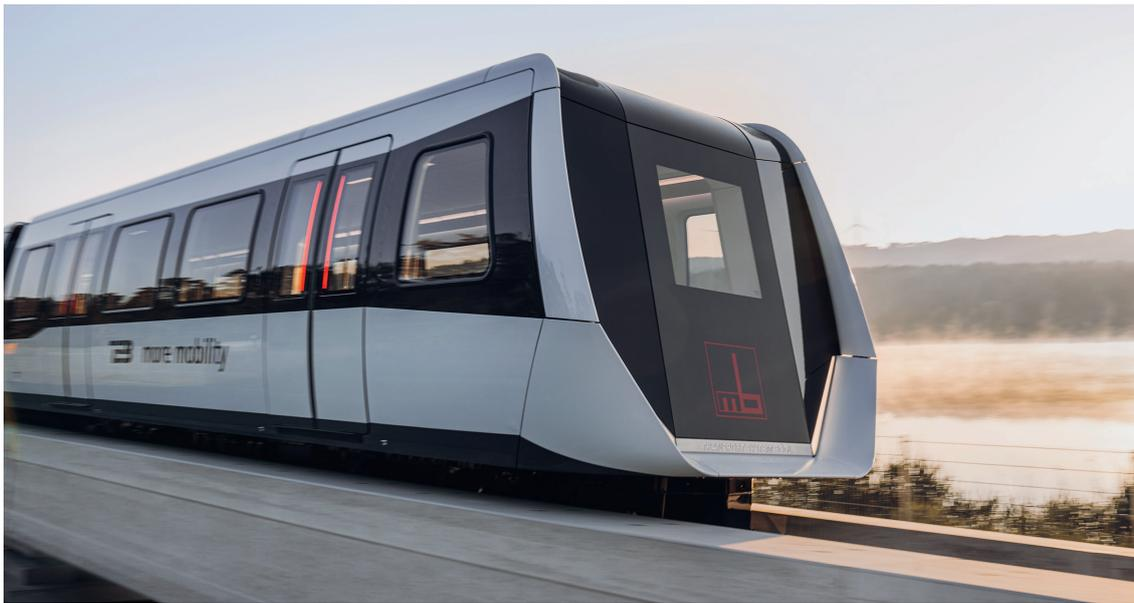
**Bild 1: Das TSB ist als fahrerloses, automatisches Personentransportsystem mit asynchronem Kurzstator-Linearantrieb und Magnetschwebbahntechnologie konzipiert.**
